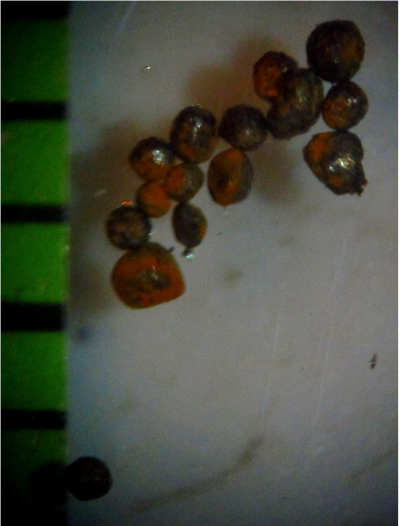
21- Sferule di netta provenienza antropica raccolte all'esterno di una industria, a poche decine di metri dalla bocca di uscita di un impianto di aspirazione da un reparto di saldatura articoli metallici, molto differenti dalle possibili
