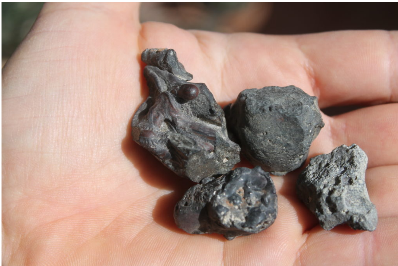
14- I frammenti di scorie ferrose, nel frammento maggiore si nota nettamente il suo aspetto di materiale fuso
